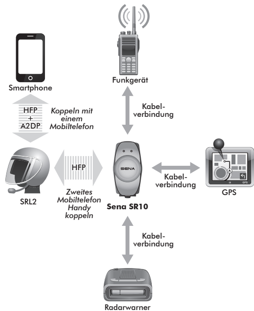
Parallele Verbindung zwischen SR10 und Mobiltelefon über Bluetooth-Kopplung mit einem zweiten Mobiltelefon
